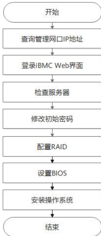
图 6-26 初始配置流程
